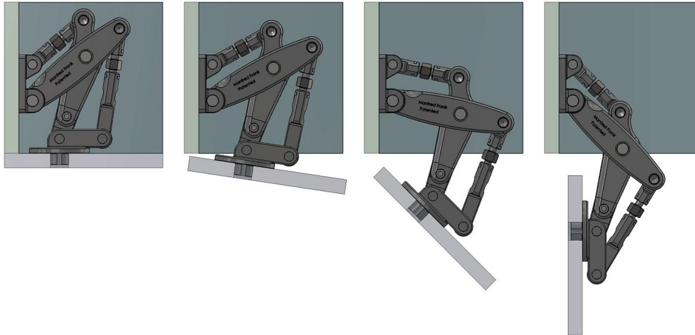
**AS THE DOOR OPENS THE HINGE GEOMETRY SIMULTANEOUSLY MOVES THE DOOR PANEL PARALLEL OUTWARD AND AWAY FROM THE FRAME.**
